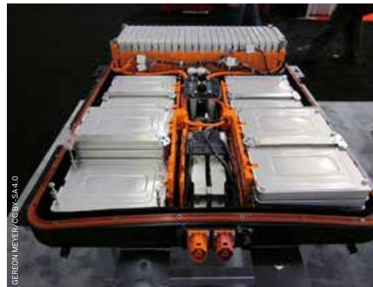
Het accupakket van de eerste Nissan Leaf, een populaire elektrische auto, bestaat uit pouches ofwel batterijzakjes.
